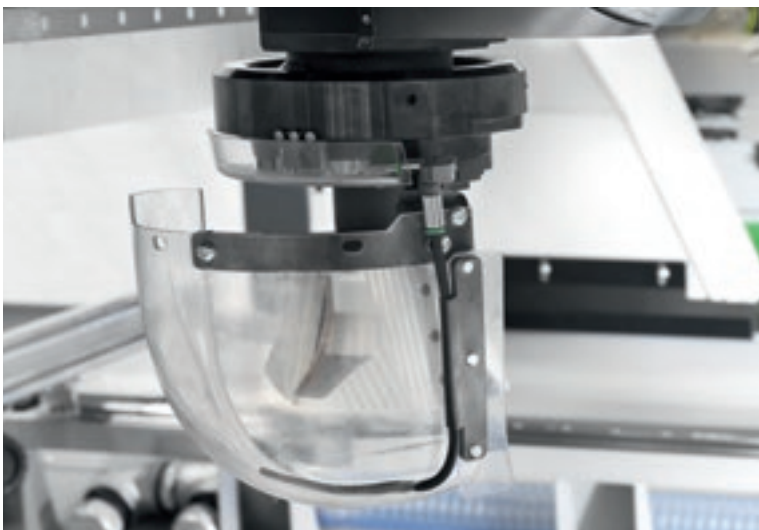
CNC-gesteuertes Späneleitsystem (Späneleitblech).
