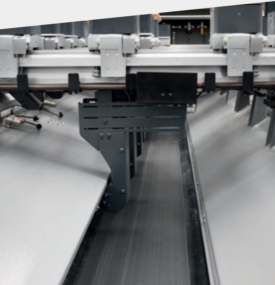
Motorisiertes Förderband zum Abtransport von Spänen und Bearbeitungsabfällen.
