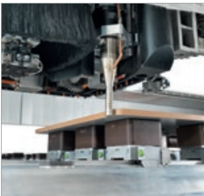
Abblaseinheit mit kalter oder warmer Luft.
