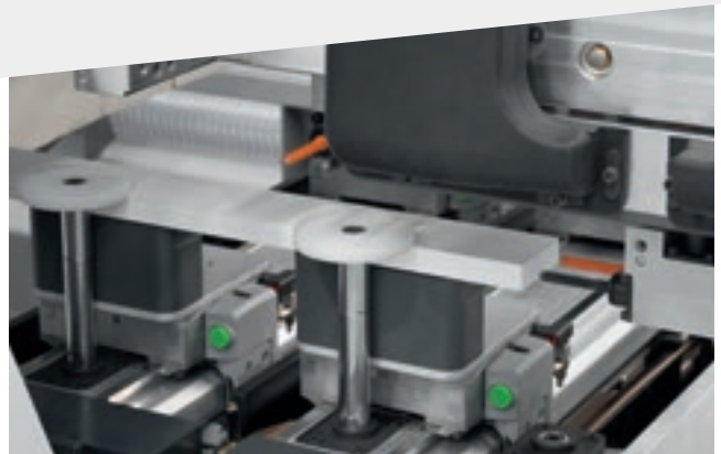
Easyclamp-Aufspannsystem für die Bearbeitung schmaler Werkstücke.
