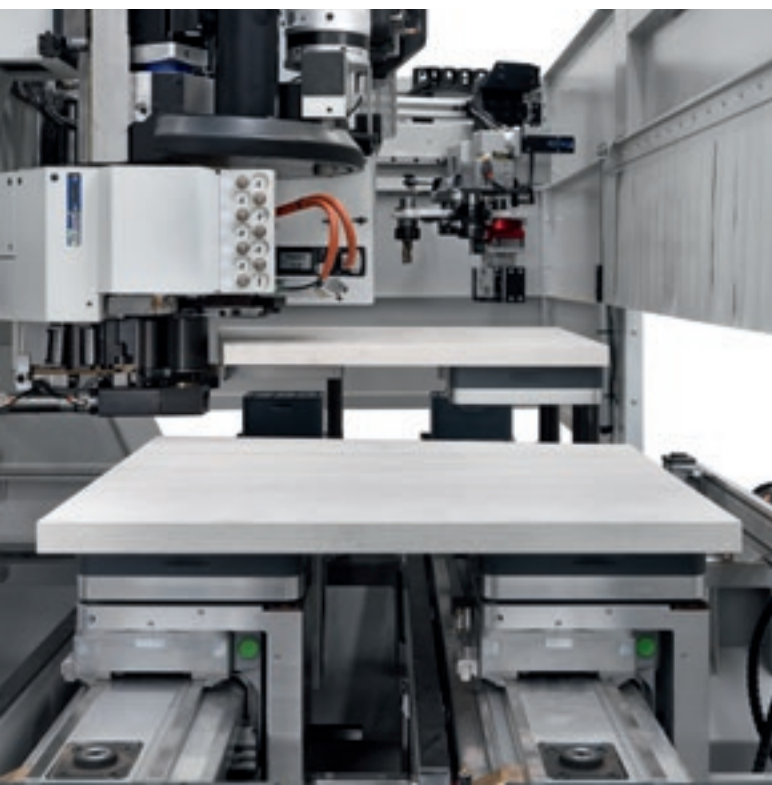
Pneumatische Aufspannsysteme Uniclamp und Hyperclamp mit Schnellentriegelung für stabiles und präzises Spannen.
